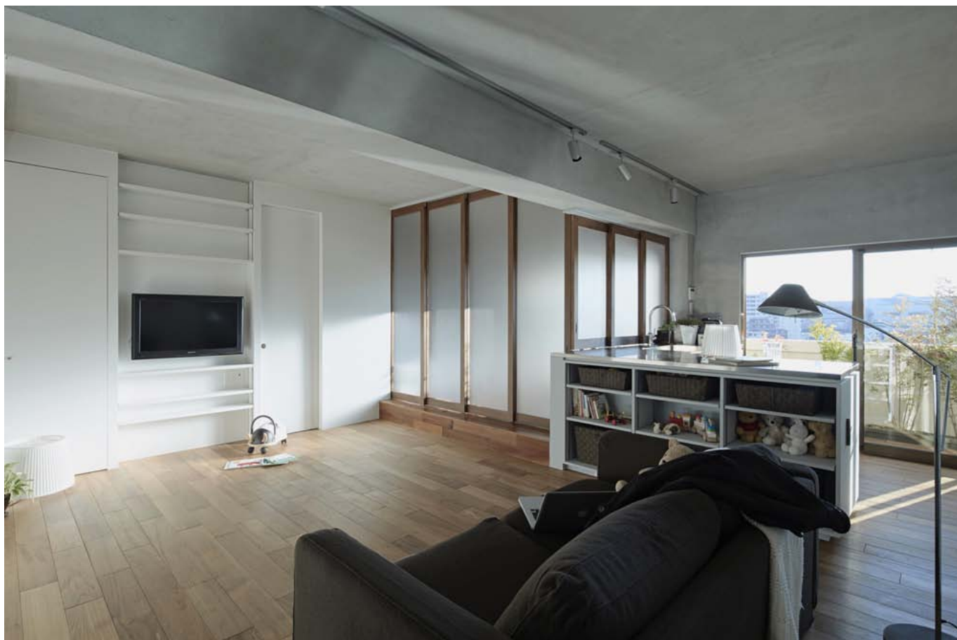
木製の引戸は半透明のポリカーボネートを設置しています。引戸を閉める事で浴室からの水と浴室入浴時のプライバシーを保護します。
