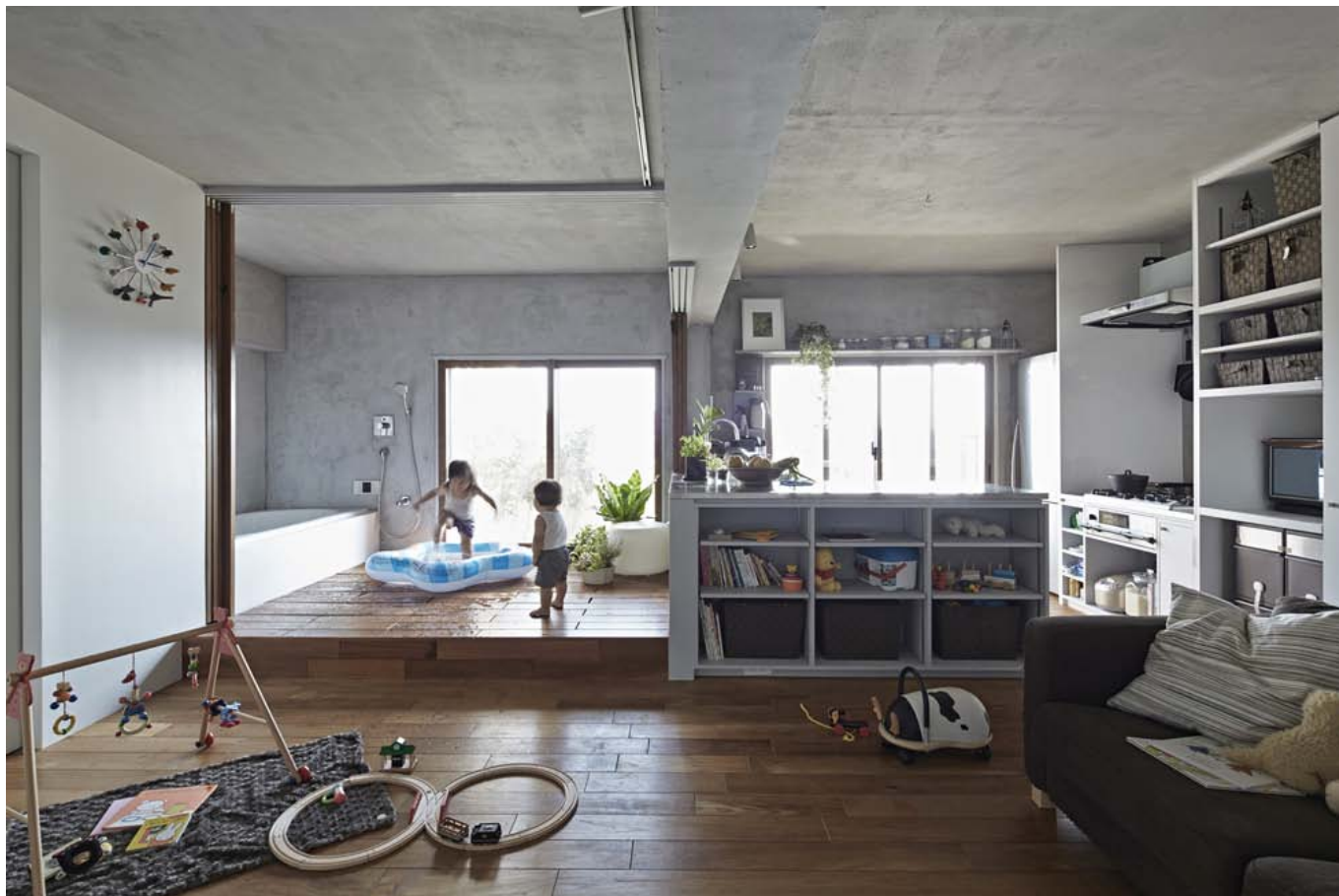
幅3m×奥行き2mの少し大きな浴室はリビングダイニングから連続した室内の遊び場であり、ビニールプールを置いて外の庭のような使い方も出来ます。水はデッキ材の隙間から排水溝に流れて行きます。
